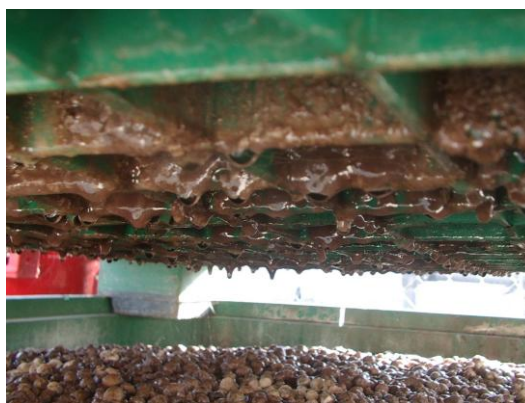
Figura 4.- Separación entre dos fases de tratamiento. (En la parte inferior se puede ver la arlita y en la superior la biomasa generada).
