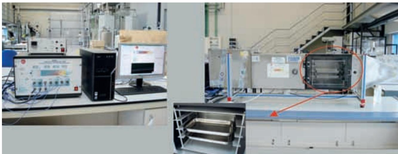
Figura 2. Planta piloto de deshidratación por convección de aire caliente. Reproducido con permiso de EDIBON Internacional, S.A. (Madrid, España).
