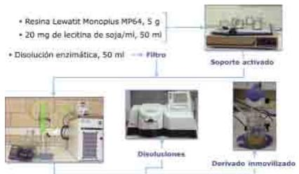
Figura 5. Esquema del proceso de inmovilización de las lipasas.
