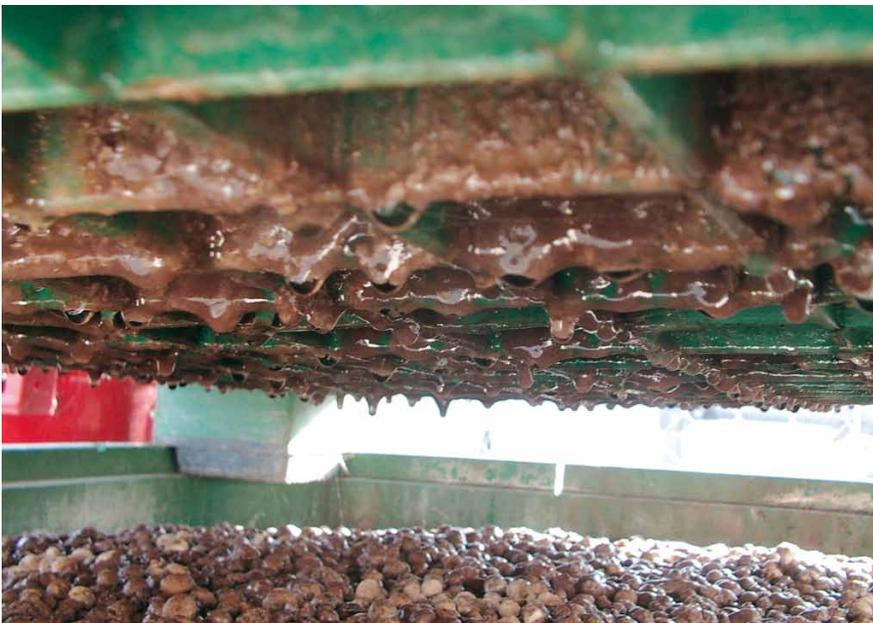
Separación entre dos fases de tratamiento. En la parte inferior se puede ver la arlita y en la superior la biomasa generada.
