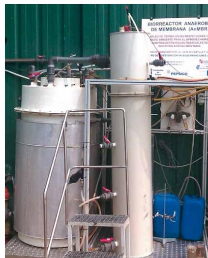
Planta piloto AnMBR usada en ensayos previos al proyecto WOGANMBR para el tratamiento de aguas residuales industriales.
