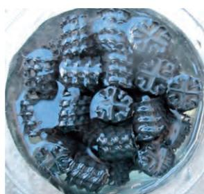
Figura 1. Detalle de un carrier con biomasa
