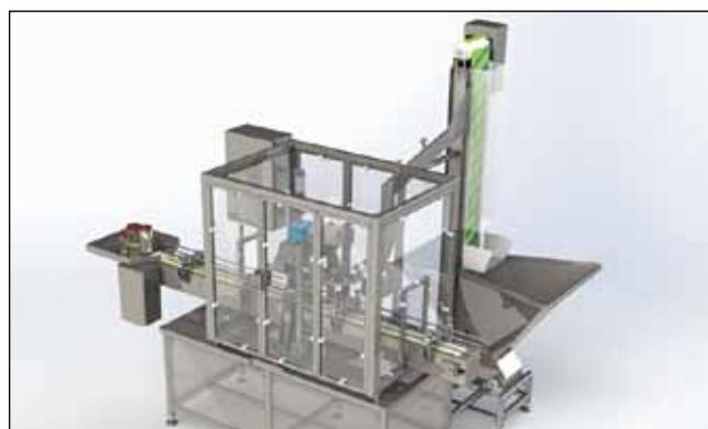
Figura 11. Vista Completa Cerradora Automática
