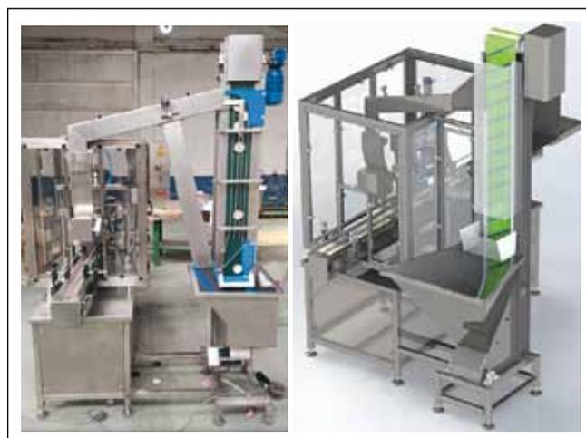
Figura 3. Elevador Tapas Original y Diseño Final del Elevador
