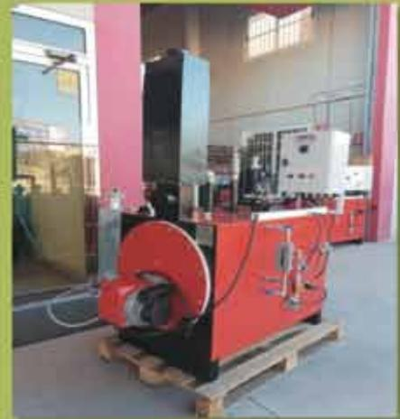
**EFICIENCIA ENERGETICA - Recuperación de calor en chimenea.** Su funcionamiento se basa aprovechar el calor latente y sensible que poseen los gases de combustión para calentar otro fluido, llegando a enfriar los gases hasta provocar la condensación del vapor de agua contenido. Con este sistema se puede llegar a conseguir un ahorro energético de hasta el 20% en la factura de combustible y rendimiento de combustión hasta 105%.
