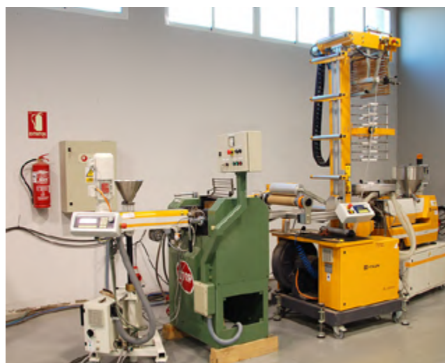
Imagen 1. Planta piloto CETEC del proceso de extrusión soplado en un cabezal tricapa
