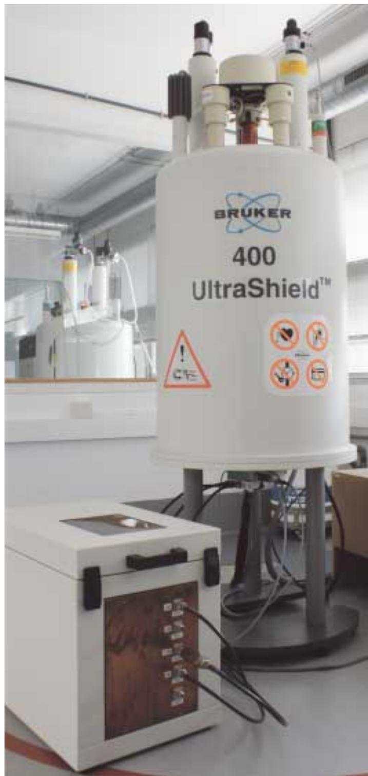
Parte del equipo de Resonancia Magnética Nuclear de 400 MHz
