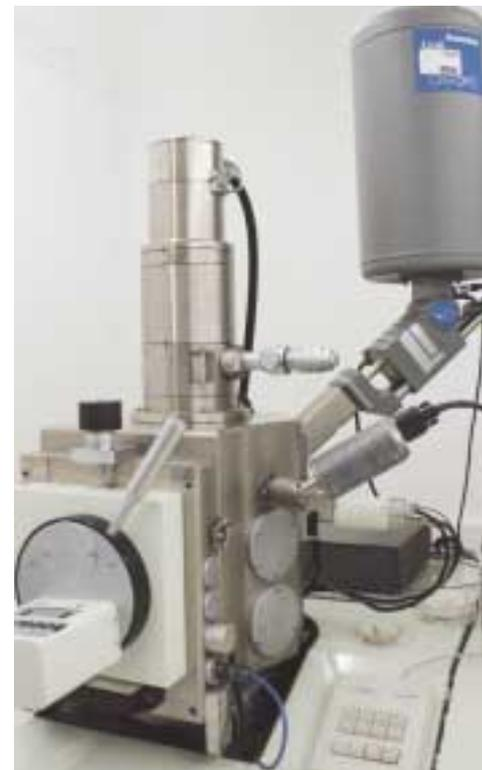
Microscopio electrónico de barrido. Dotado con detector de rayos X para cuantificar la composición de elementos.
