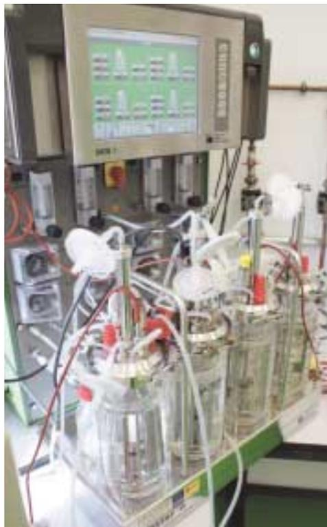
Fermentador Braun Biostat Q con cuatro cubas independientes de un litro de capacidad cada una de ellas.
