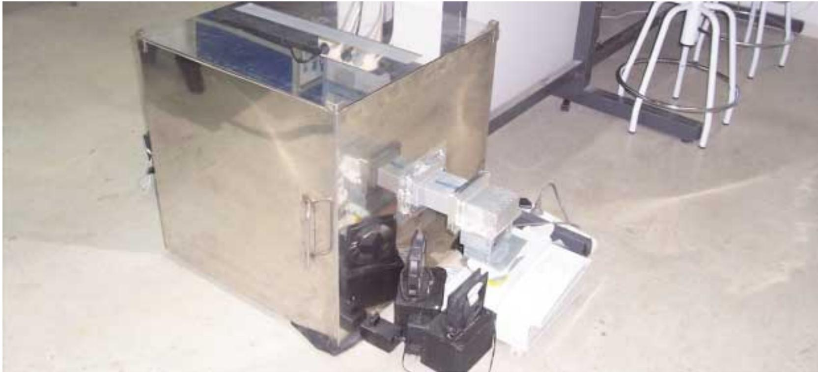
Prototipo de laboratorio (GEM-UPCT) para el estudio del calentamiento por microondas en procesos de producción por lotes.
