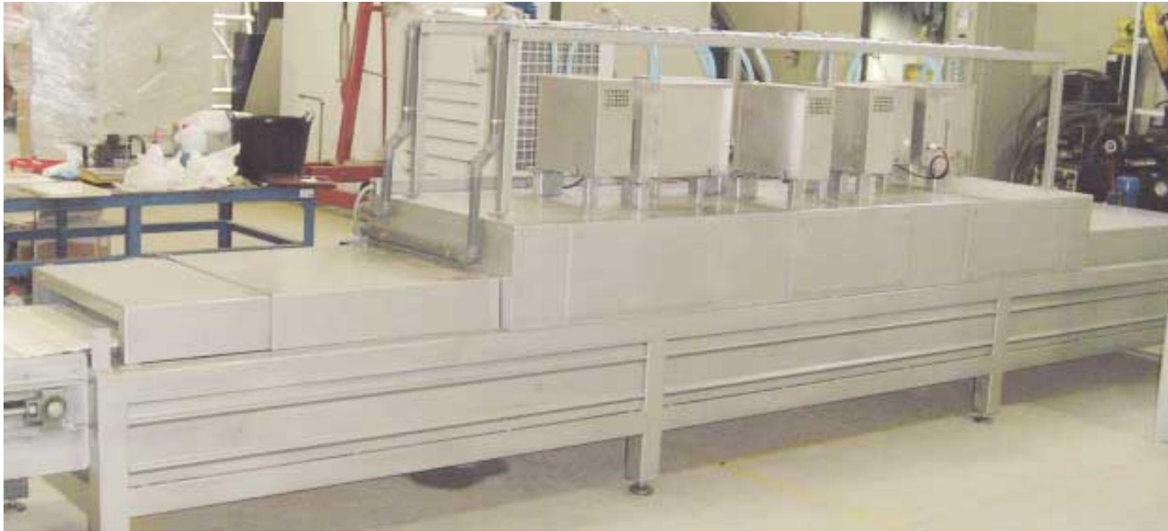
*Horno industrial de calentamiento por microondas en continuo de 6 metros de longitud y 9KW de potencia.*
