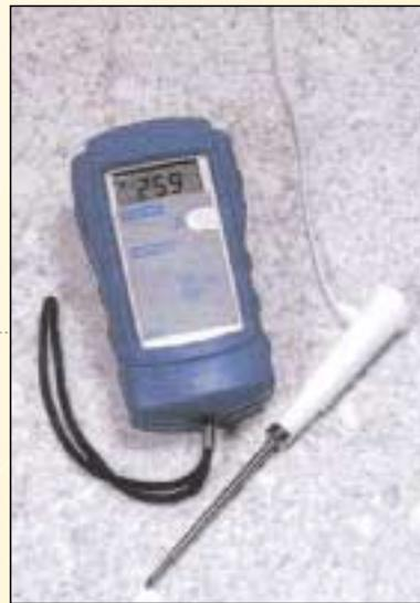
**El HI 93503 basado en termistor mide la temperatura sobre un rango completo de -50 a 150°C con una resolución de 0.1°C. Se suministra, el HI 93503, junto con la robusta sonda HI 765PWL.**
