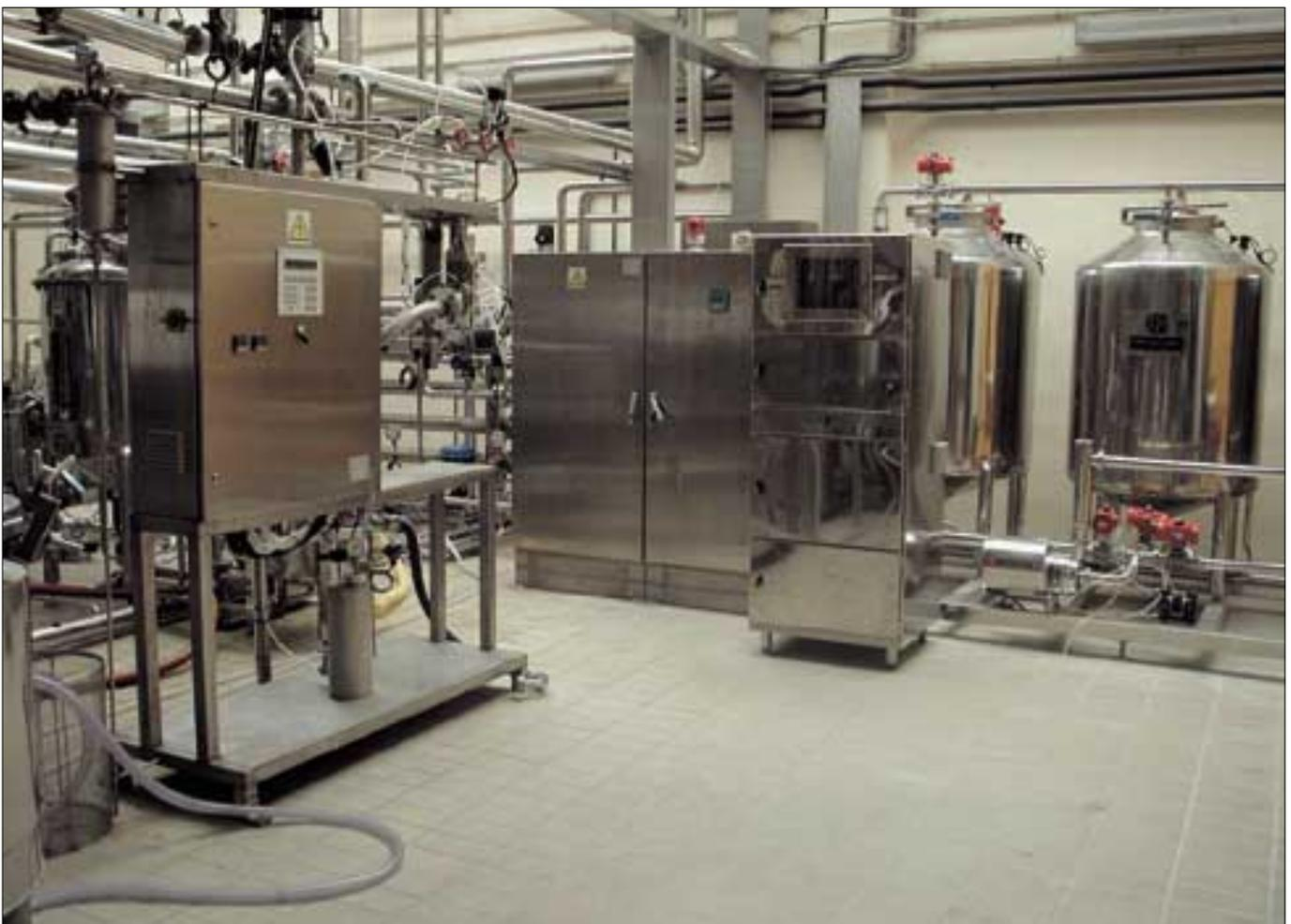
Fotografía de una zona de la Planta Piloto: sistema C.I.P., llenadora aséptica y PC de control.
