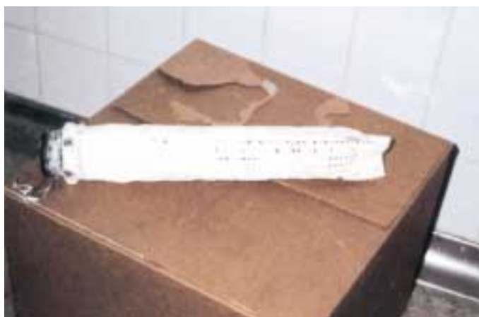
Figura 2. Tubería de entrada del vapor al depósito superior de un autoclave tipo Rotamat, incrustada durante su normal operación.
