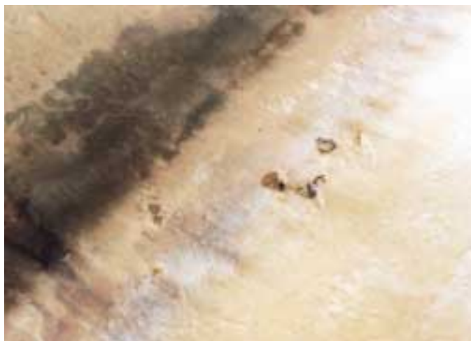
Figura 5. Corrosión bajo depósito en la zona de precalentamiento de un esterilizador hidrostático.
