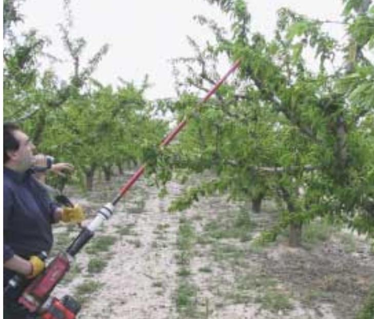
Figura 4. Vibrador térmico de mochila.
