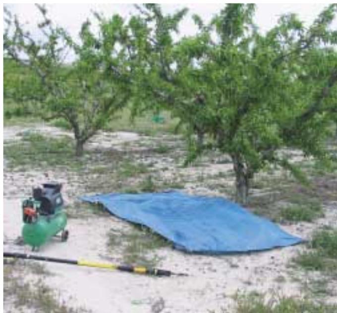
Figura 5. Vibrador manual neumático.
