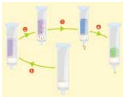
**Figura 5.** Etapas en la extracción en fase sólida (SPE): (1) Acondicionamiento, (2) carga de muestra, (3) lavado y (4) elución. (●) Sustancia interferente, (▲) analito.
