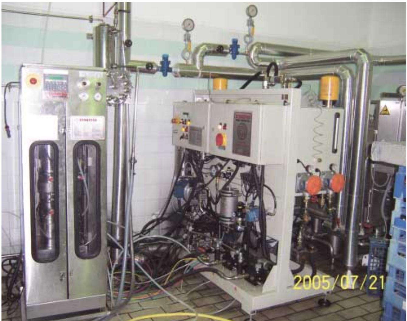
*La alta presión de homogeneización (10 a 40 MPa), se utiliza convencionalmente en la industria lechera y en la elaboración de numerosos alimentos líquidos de carácter coloidal.*
