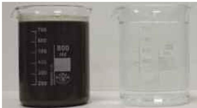
Figura 3. Permeado de Osmosis Inversa (a la derecha) en comparación con el OMWW inicial (a la izquierda).
