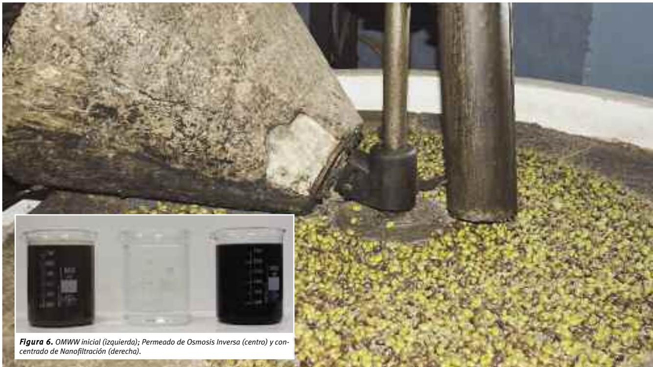
Figura 6. OMWW inicial (izquierda); Permeado de Osmosis Inversa (centro) y concentrado de Nanofiltración (derecha).
