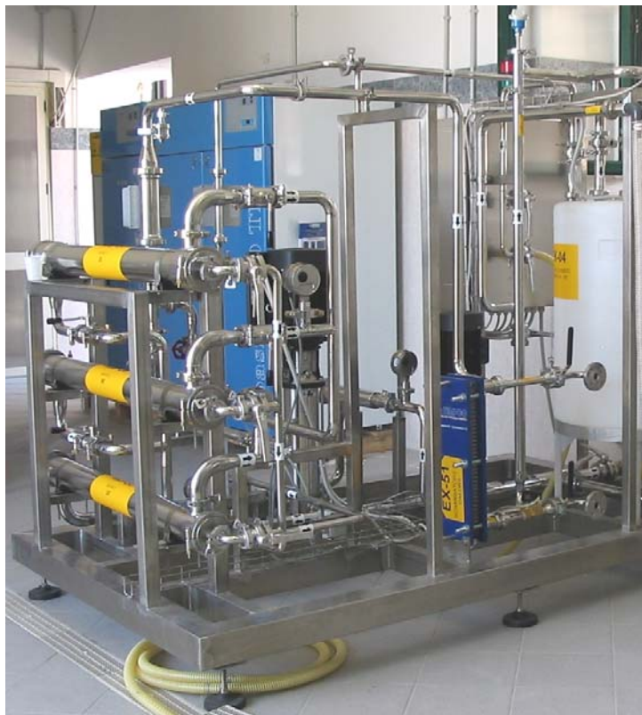
Figura 2. Planta piloto para tratamiento de OMWW: sección de ultrafiltración polimérica – nanofiltración – ósmosis inversa.
