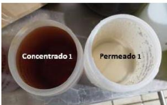
Efluente después de nanofiltración
