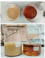
Efluente después de ultrafiltración
